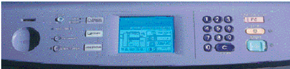
Panel de control ergonómico: Teclas extra grandes de inicio y de funciones frecuentes.
